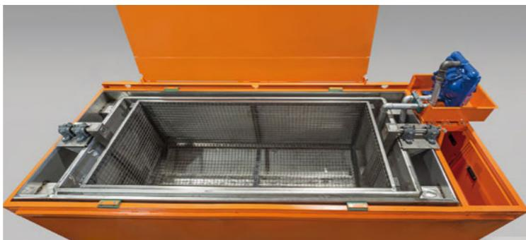
Die Kerntauchmaschine KTM wird eingesetzt zum Tauchen von Sandkernen in einer wasserlöslichen oder alkoholhaltigen Schlichte.
