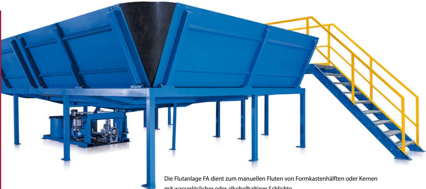
Die Flutanlage FA dient zum manuellen Fluten von Formkastenhälften oder Kernen mit wasserlöslicher oder alkoholhaltiger Schlichte.
