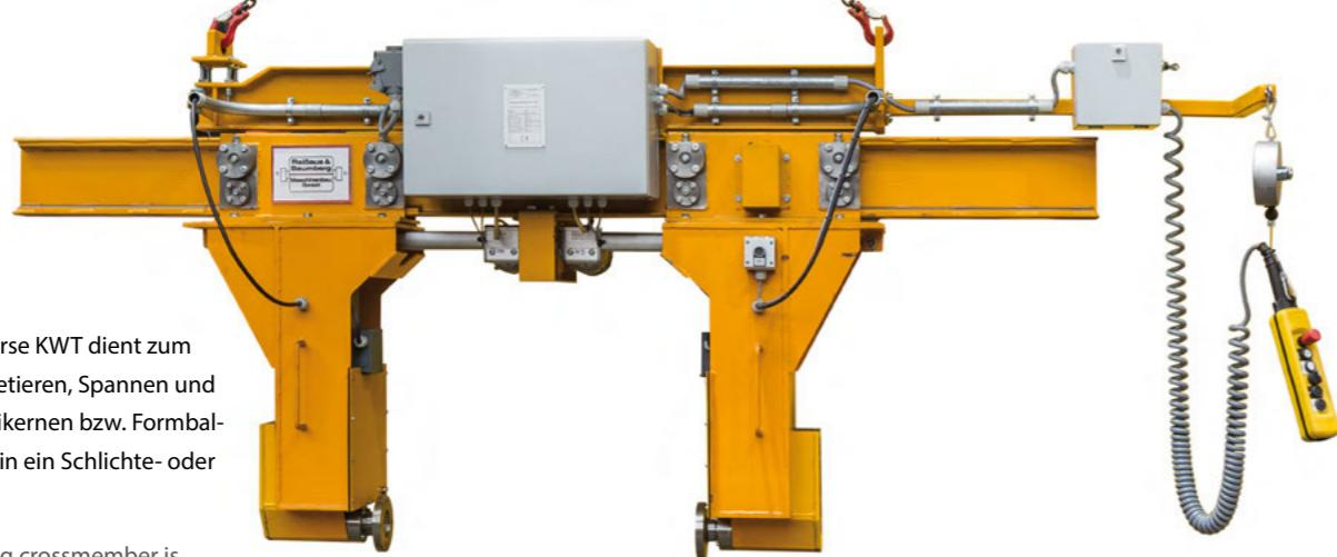
Die Kernwendetraverse KWT dient zum formschlüssigen Arretieren, Spannen und Drehen von Gießereikernen bzw. Formballen zum Eintauchen in ein Schlichte- oder Flutbecken.
